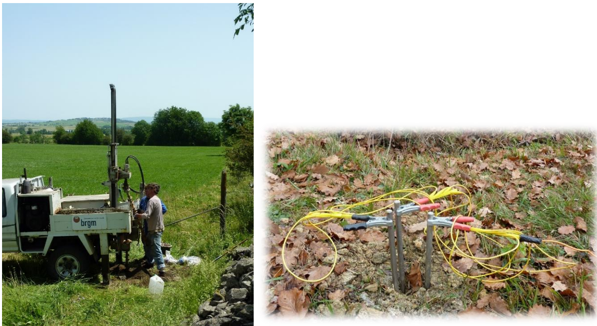
Figure 18 : Gauche : tarière typiquement utilisée pour l'installation des électrodes d'injection. Droite : électrodes d'injection après installation.
