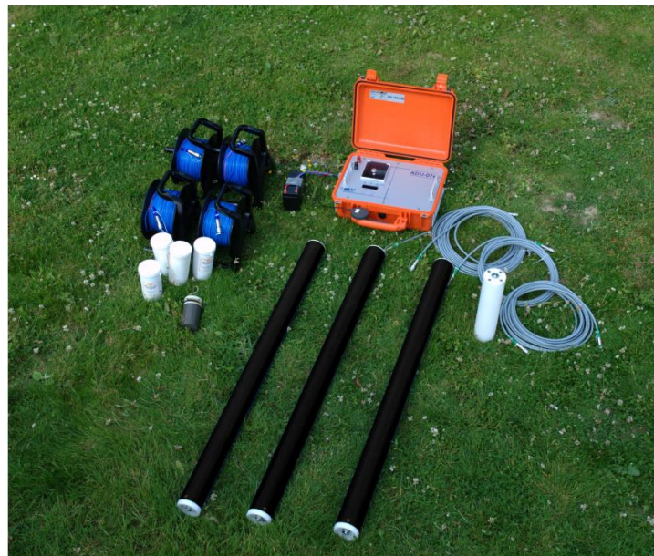
Figure 19 : Matériel utilisé pour un récepteur électromagnétique.
